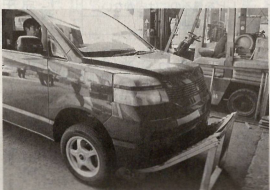
衝突実験で、車止め柵に阻まれて停止した試験車両
